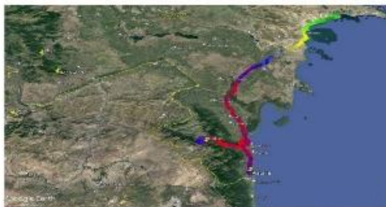
Şəkil 4. Bakı - Astara - Lerik magistral avtomobil yolu üzrə “Azərbaycan” radiosunun FM elektrik sahə gərginliyinin dəyişməsi
