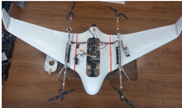
Şəkil 1. BNÖS quraşdırılmış konvertoplan tipli PUA
